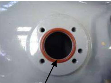
Oリングが容器取り付け部にしっかりと配置された状態で、部品を固定してください。
