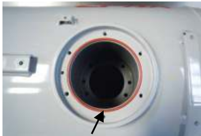
ガスケットが容器取り付け部にしっかりと配置された状態で、部品を固定してください。
